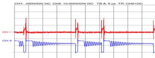
Sl. 4. Struja kalema i napon na drejnu pri malom opterećenju
