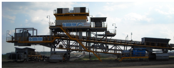
Sl. 6. Izgled jednog realizovanog tračnog transportera sa regulisanim pogonom 4x1,2 MW u sklopu V BTO sistema
