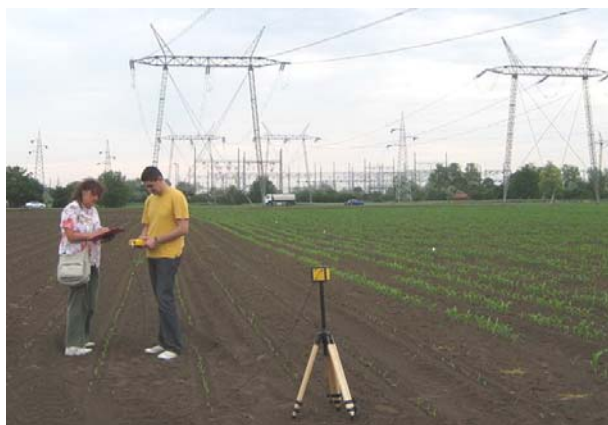
Slika 3. Merni sistem EFA-300 za merenje električnog polja u okolini dalekovoda na Rimskim Šančevima.
