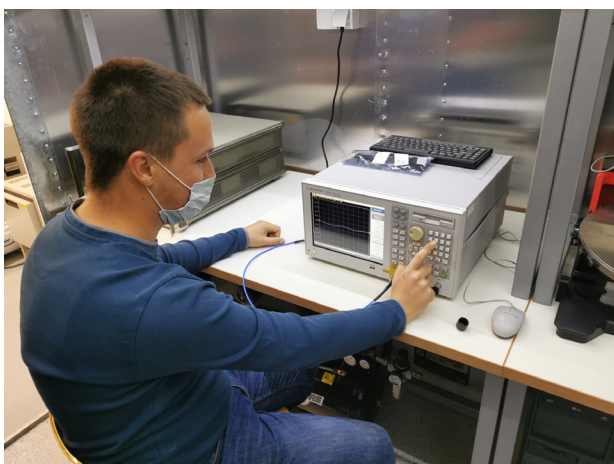
Sl. 3. Vektorski analizator mreže Agilent E5071B (Vector Network Analyzer)
