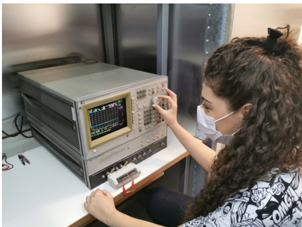
Sl. 3. Vektorski analizator mreže Agilent E5071B (Vector Network Analyzer)
