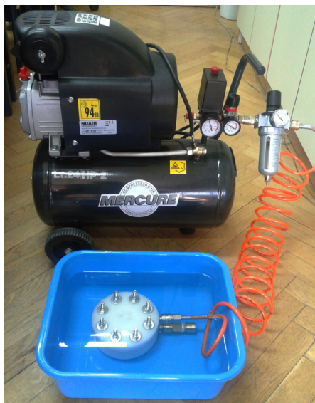
Sl. 9. Postavka za testiranje držača senzora pod vodom
